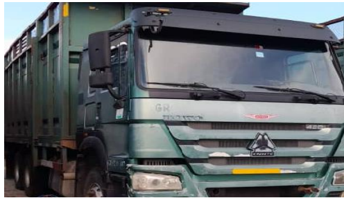
Fig.2.1. Camión SINOTRUK HOWO 6x4 de 20 t de capacidad.
