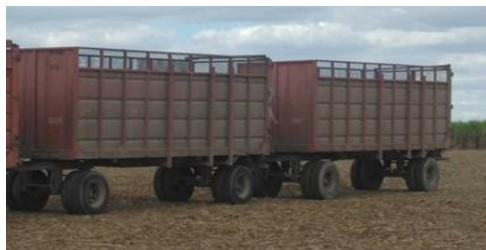
Fig.2.2. Remolque agrícola con capacidad de 20 t marca TAÍNO.
